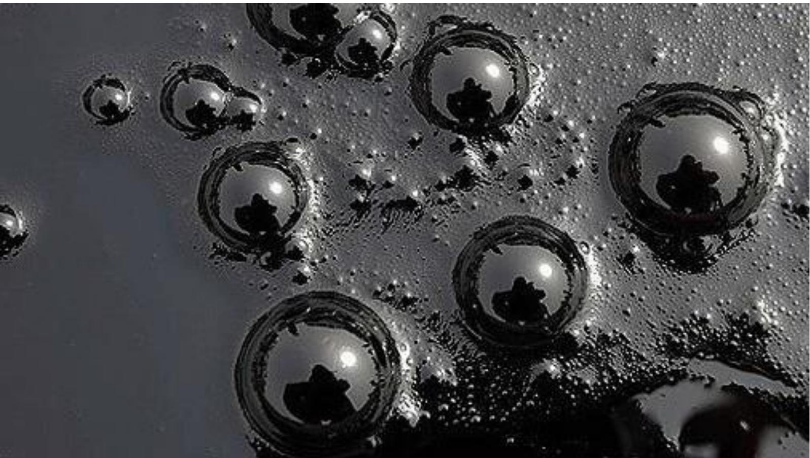
Le emulsioni bituminose sono una dispersione di bitume sotto forma di minutissime goccioline (fase dispersa) in acqua (fase continua). Osservate al microscopio le emulsioni bituminose appaiono come particelle di forma sferica con diametro variabile da 0,1 a 10 micron. Le emulsioni bituminose contengono dal 45 al 70% di bitume ed il resto è acqua, sono liquide, viscoso e di colore marrone.
